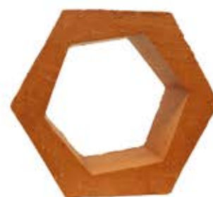
Cobogó Alveare - Cód 666 Dimensão: 22x22x6,8 18 peças p/m 2
