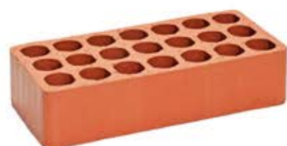
Tijolo Lâminado 21 furos - Cód 26 Dimensão: 24x11,5x5,3 cm 75 peças p/m 2
